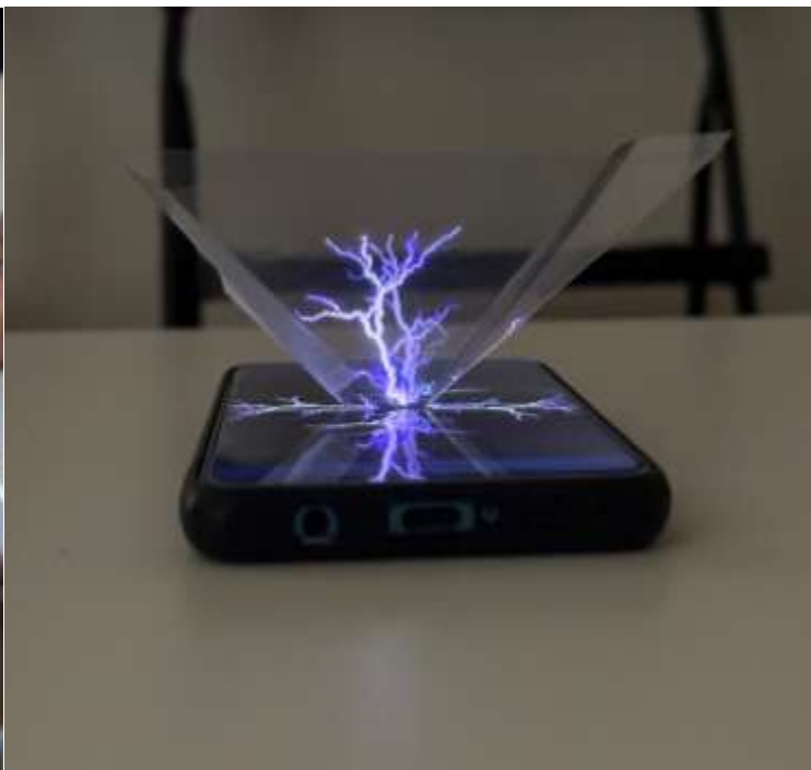
Slika 6: Izdelava holograma iz plastične folije
